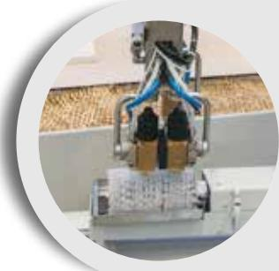
**SISTEMA DI PULIZIA DELLE PISTOLE AUTOMATICO E PROGRAMMABILE.
