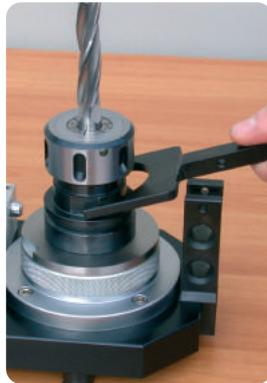
**ACCESSORIO DI BLOCCAGGIO/ TIGHTENING DEVICE**
