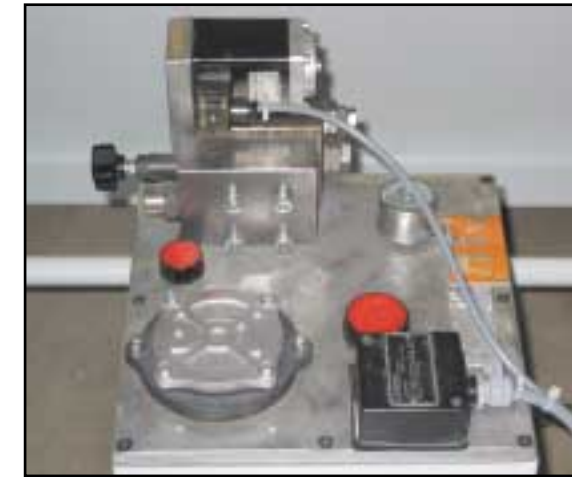
Pompa doppia con valvola disgiuntiva Two stage pump with pressure relief valve doppelte Pumpe mit Druckentlastungs-Ventil
