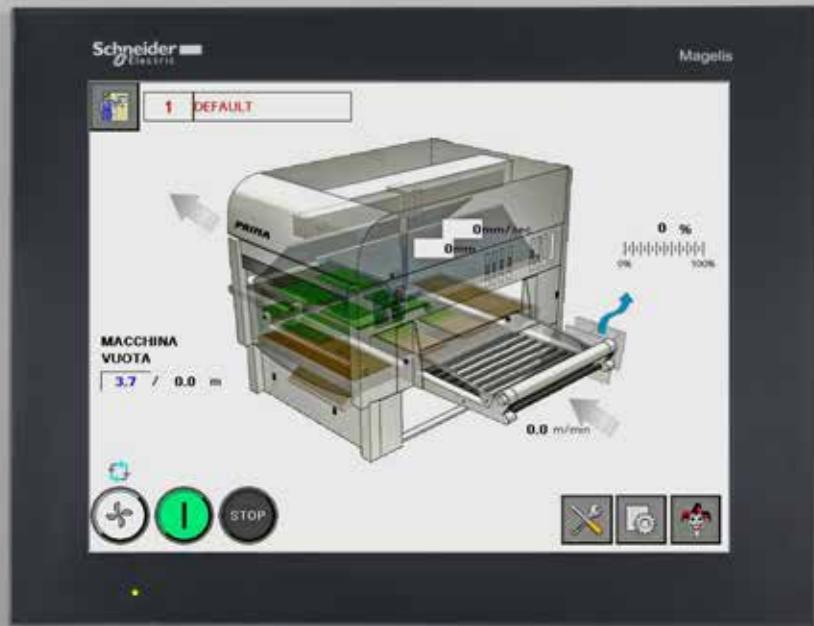
Quadro elettrico di controllo con PLC e software di gestione macchina, comandati da touch screen a colori 12,1".
