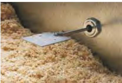
Option: Der Füllstandsmelder startet die Presse automatisch, wenn das Material das Füllstandspaddel erreicht.
