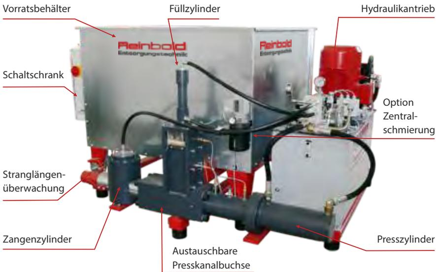
Die Pressen verfügen über großvolumige Vorratsbehälter mit integrierter Förderschnecke. Das Material gelangt über die Förderschnecke in den Füllzylinder und wird dort mittels des Füllzylinders vorkomprimiert in den Presskanal befördert. Dort wird das zu verpressende Material durch den Presszylinder solange in die konisch geschlossene Zange gepresst, bis die gewünschte Härte des Briketts erreicht ist. Dann öffnet sich die Zange und das Brikett wird herausgedrückt.
