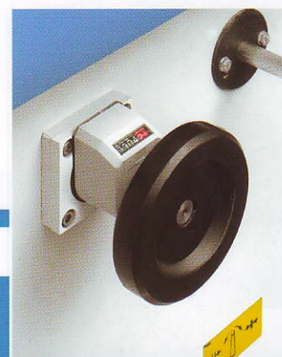
Цифрова индикация за положението на работната маса Digitalanzeige für die Dickentischhöhenverstellung Digital read-out for the working table position
