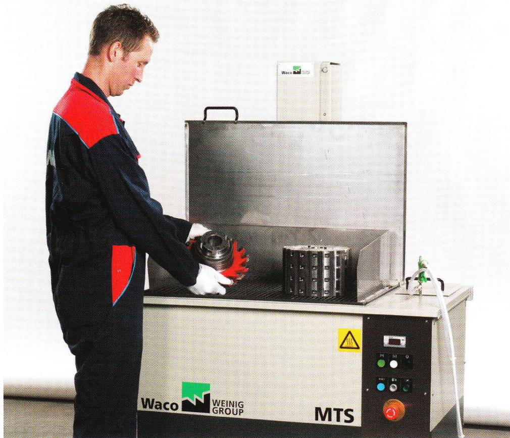
**Förbättrad arbetsmiljö** och ökad produktivitet med WACO MTS, ett automatiskt system för rengöring av verktyg från kåda och annan beläggning. Verktygens alla ytor, håligheter och kanaler tvättas snabbt och effektivt genom att systemets verktygsplattform lyfts och sänks i ett vätskebad. Systemet arbetar tystgående.
