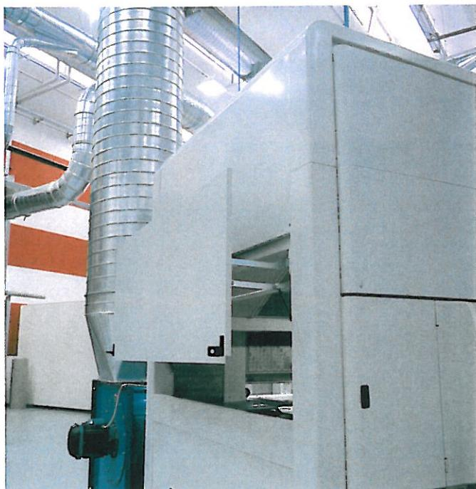
L'accessibilità posteriore facilita le operazioni di manutenzione e pulizia.
