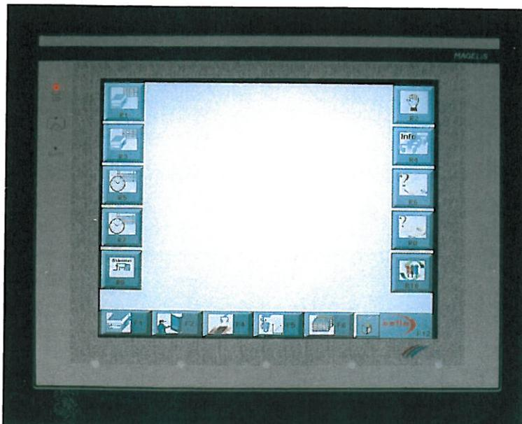
Menu di attivazione manuale delle funzioni della macchina e di visualizzazione dei parametri di produzione.
