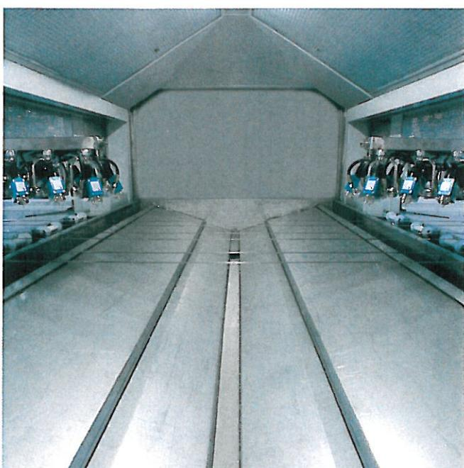
Zona di spruzzatura, con sistema di aspirazione ad acqua.
