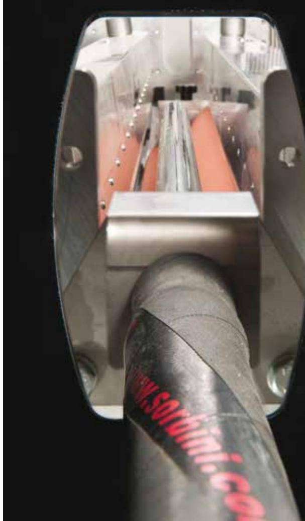
Alimentazione vernice e visibilità totale degli elementi di maggiore utilizzo quali vernici, rulli e racle all'interno della macchina.
