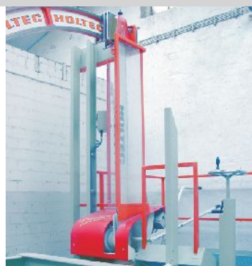
Standardanlage mit manueller Schwenkbewegung und Positio- nierung
